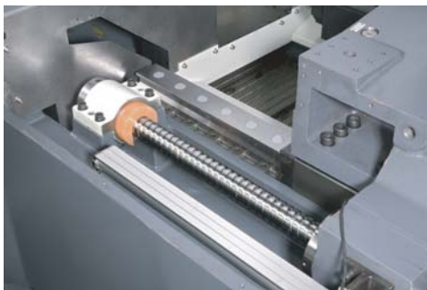
Eksenlerde opsiyonel lineer cetvel ile ölçüm
