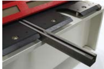
Çetvelli, stoperli ve T-kanallı ön destek kolları T-slotted front support arms with scale and flip-stop
