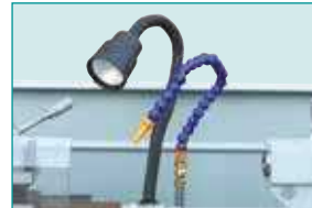
Aydınlatma Lambası & Soğutma Sistemi
