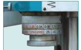
Hidrolik Devir &amp; İlerleme Ayar Skalası
