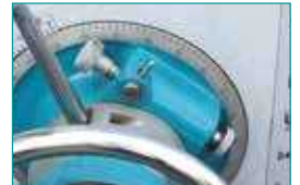
Delme Derinlik Ayar Mekanizması
